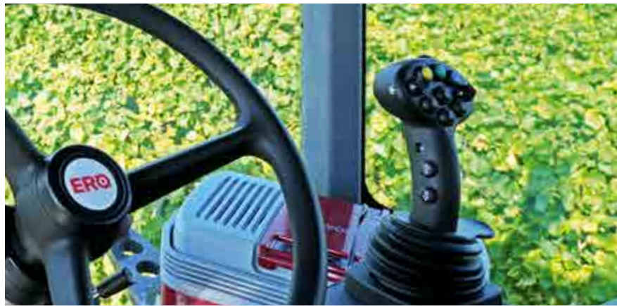
Der ergonomische Joystick zur Bedienung aller wichtigen Funktionen.
