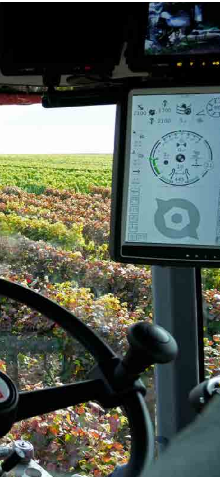
Der ergonomische Joystick zur Bedienung aller wichtigen Funktionen.
