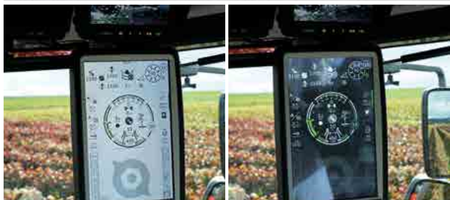
Die Geschwindigkeitsregelanlage sorgt für eine gleichbleibende Erntegeschwindigkeit. Das intuitiv bedienbare Display bietet einen Tag- und einen Nachtmodus
