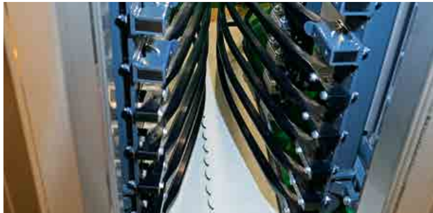
Nadelgelagerte Schuppenbahn und Doppelschüttelwerk.
