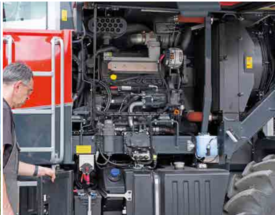
Drei AGCO Power Motorvarianten. Für Wartungsarbeiten durch Öffnen der Motorklappe leicht zugänglich.
