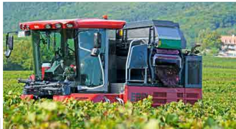
Die Abbeermaschine lässt nur bestes Lesegut in den Traubentank.
