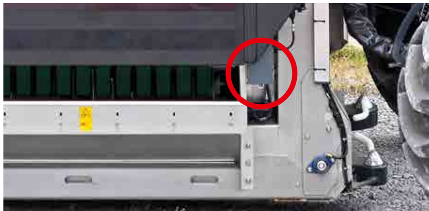
Höhenanzeige über Ultraschallsensor.
