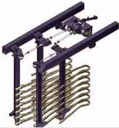
Das Schüttelwerk: Die Flexibilität der Schüttelstäbe kann individuell eingestellt werden.
