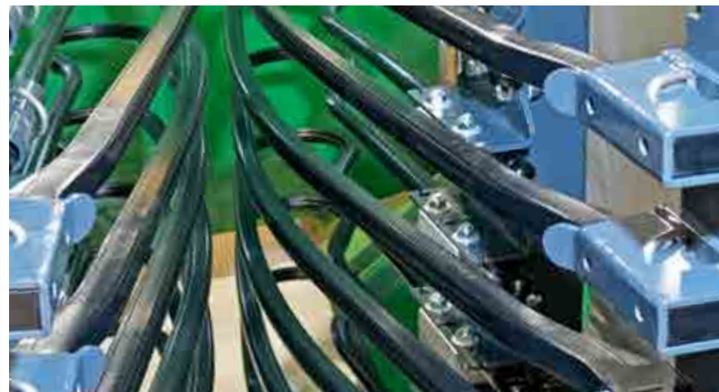
Der rechteckige Querschnitt der Schüttelstäbe sorgt für gleichmäßige Abnutzung und längere Lebensdauer.
