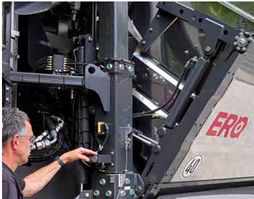
Beim Waschen der Maschine kann der Traubentank über am Rahmen angebrachte, gut erreichbare Taster entleert werden.
