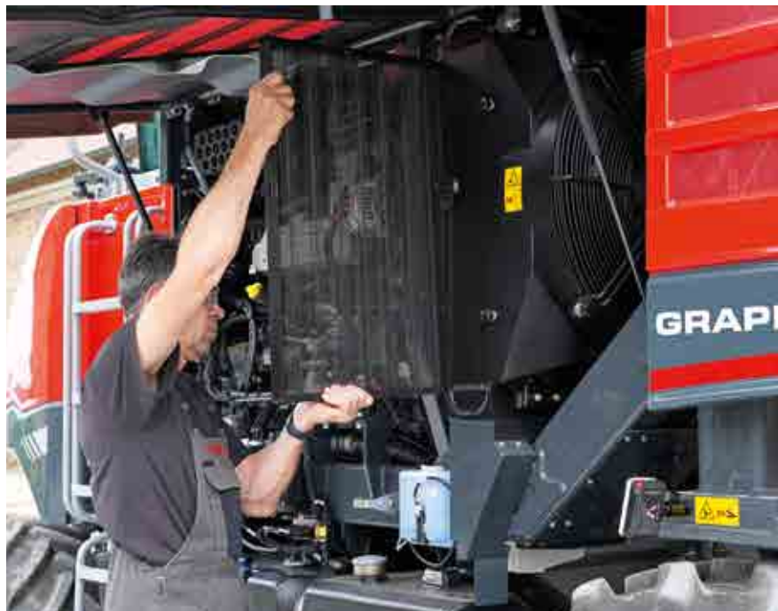
Alle Wartungsteile am Motor sind von einer Seite aus zugänglich.
