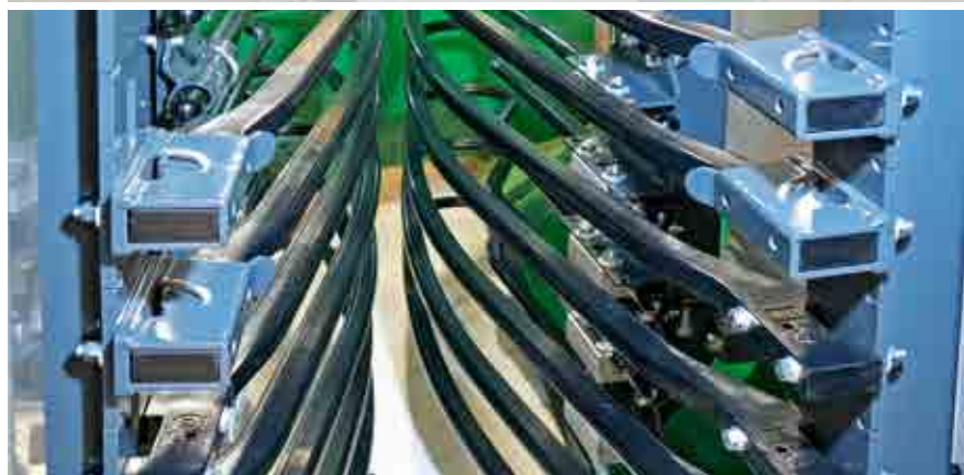
Schnellverschlüsse (Option) an den Schüttelstäben, zum schnellen Ein- und Ausbau im Weinberg.
