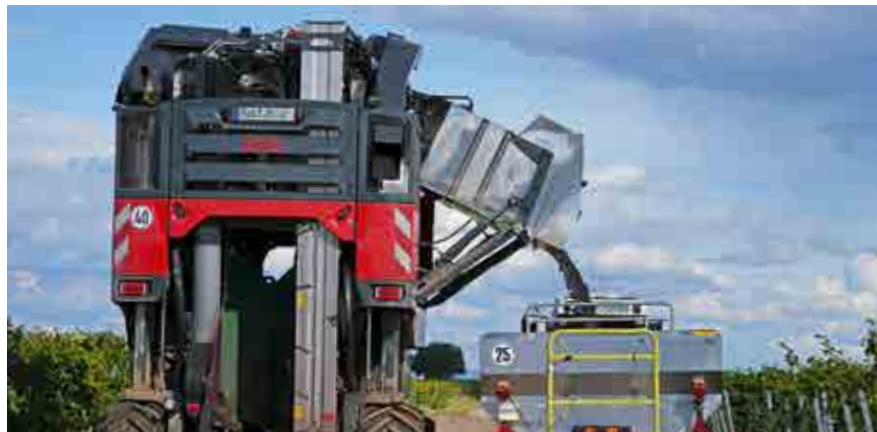
Die seitliche Entleerung bietet gute Übersicht und benötigt nur etwa ein Drittel der Zeit im Vergleich zur Entleerung nach hinten.
