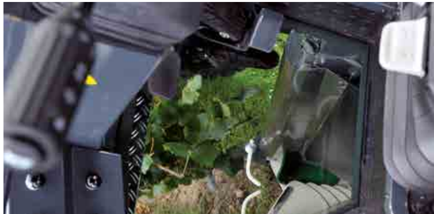
Der verglaste Kabinenboden bietet freie Sicht auf die Rebzeile.
