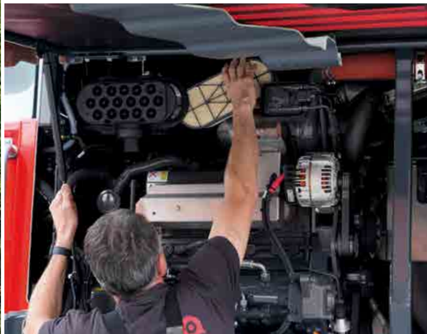
Der Luftfilter ist mit einem Handgriff zu wechseln.
