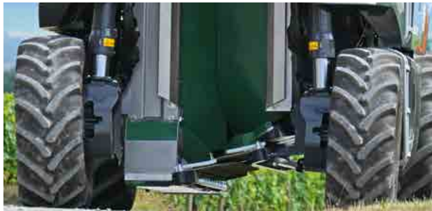
Automatische Lenkung: Der Grapeliner 8000 wird sicher über die Rebzeile hinweg geführt.
