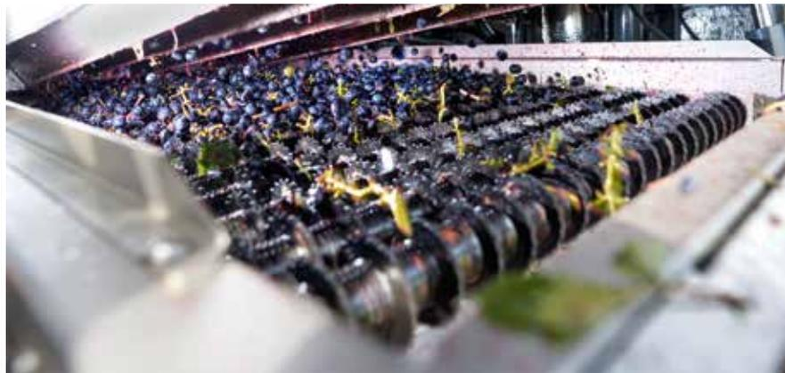
Direkte Sicht auf die Sortierrollen. Hydraulische Weiten- und Geschwindigkeitverstellung vom Fahrersitz aus.
