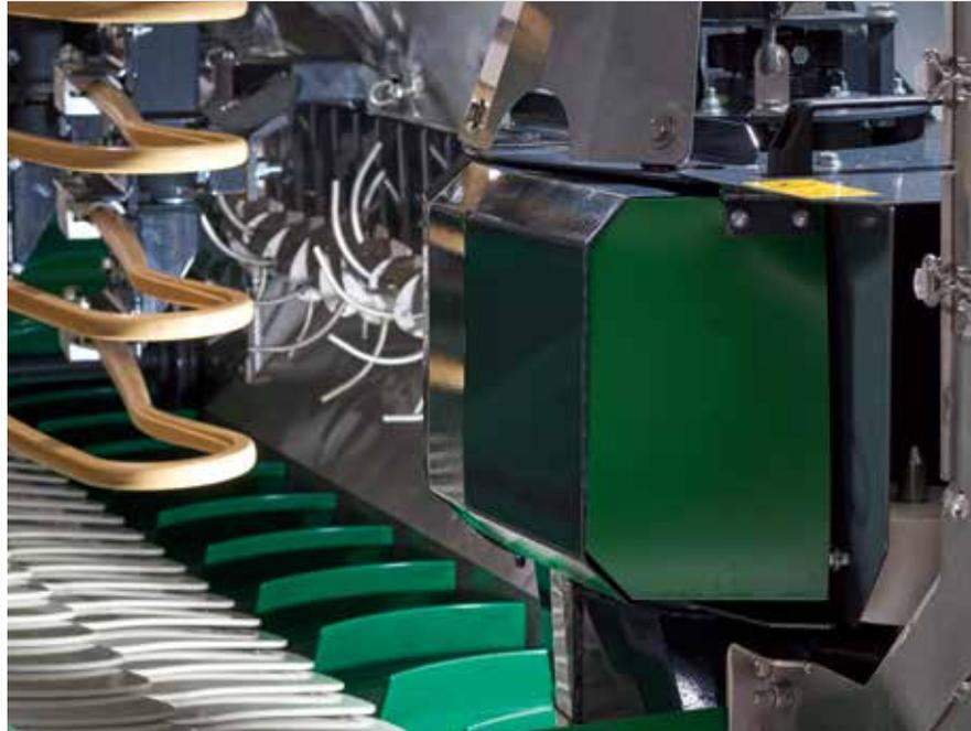
Die flexible Seitenwand des Sauggebläses weicht bei Hindernissen aus, Schäden werden so vermieden.
