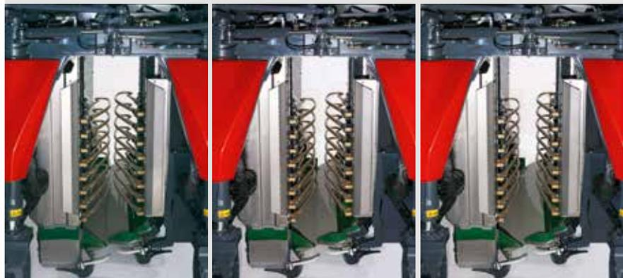
Die Durchgangsverstellung und die Schnellwechselhalter der oberen Schüttelstäbe (optional) ermöglichen eine werkzeuglose Anpassung an unterschiedliche Erziehungsformen.
