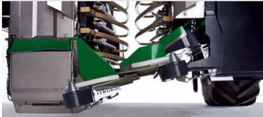
Weniger Verschleiß, Wartungs- und Reinigungsaufwand - das einseitige Fördersystem bietet viele Vorteile. Für einen optimalen Materialfluss sind beide Schuppenbahnen winkelverstellbar.
