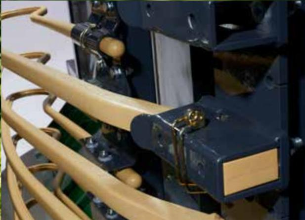
Schüttelstäbe mit Schnellwechselhalter zum werkzeuglosen Einbau zusätzlicher Stäbe im Weinberg.
