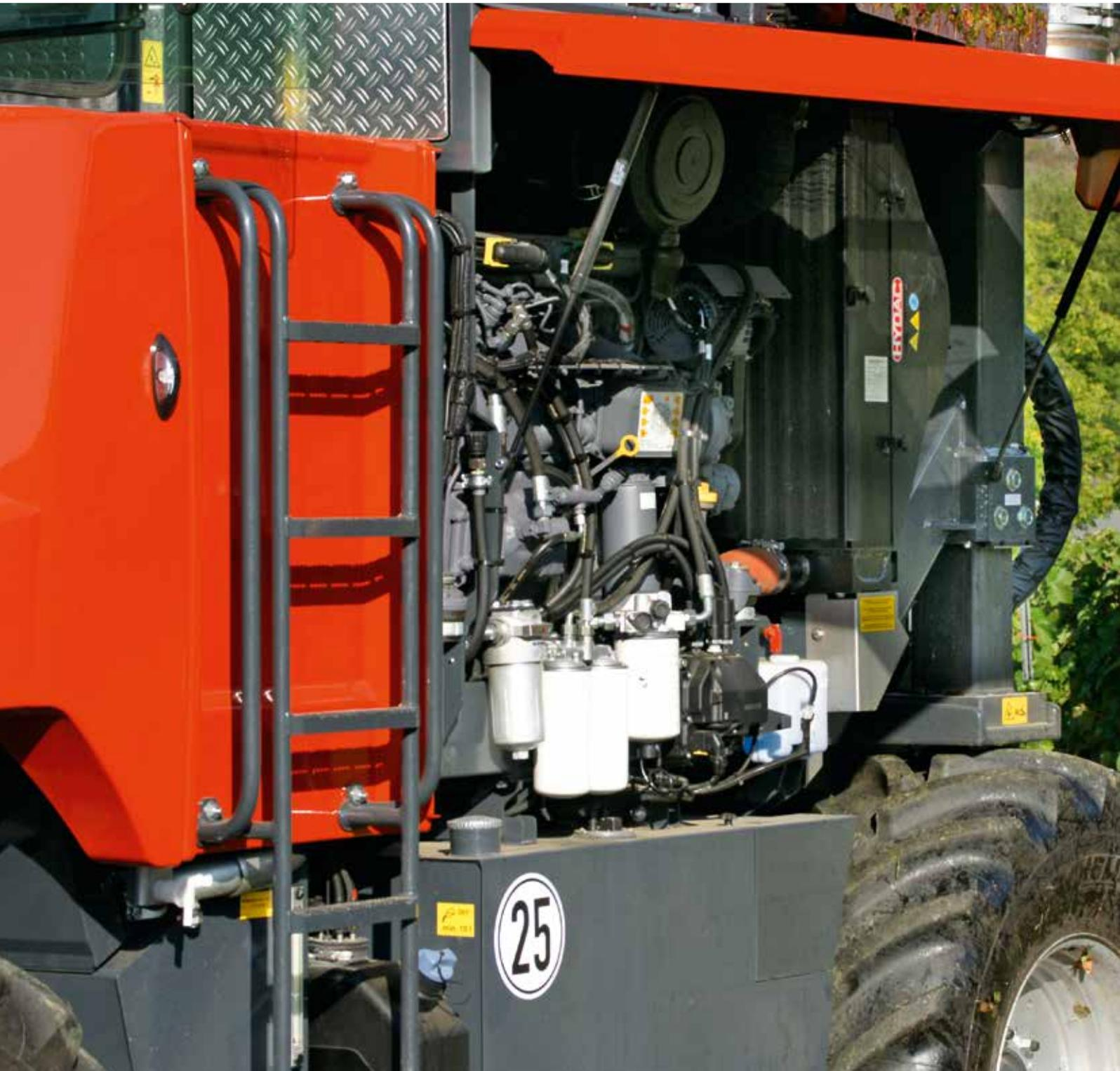
Egal ob auf dem Hof oder im Weinberg - Motor, Förderband und Entrapper sind schnell und einfach zu erreichen. Die abgedichtete obere Plattform schützt den Motorraum vor Wasser und Schmutz. Ecken und Kanten, an denen sich Schmutz anlagern könnte wurden vermieden.
