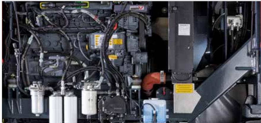
Neueste DEUTZ® Motorgeneration in zwei Leistungsstufen: 6 Zylinder, 6057 cm<sup>3</sup> Hubraum, Abgasstufe EURO 5 mit 143 PS oder 175 PS
