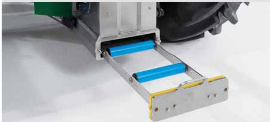
Die Rollenführung unterhalb des Förderbandes reduziert die Bandreibung und damit den Verschleiß des Förderbandes. Zur Reinigung lässt sie sich leicht ausziehen.
