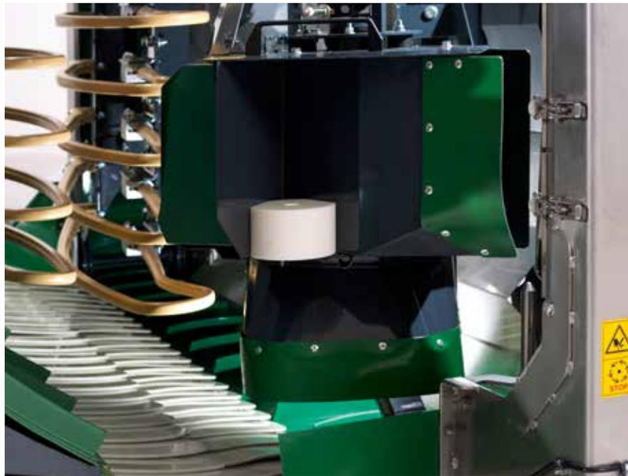
Elektrisches Heben und Senken des unteren Sauggebläses ermöglicht einen einfachen Zugang und eine gründliche Reinigung.
