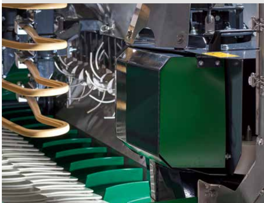
Paroi latérale de l'aspirateur flexible pour éviter les obstacles et prévenir ainsi les dommages.
