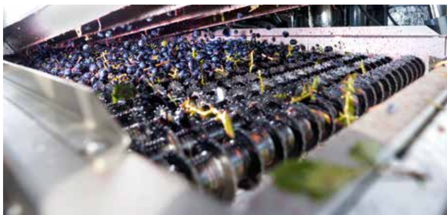
Vue sur les rouleaux de tri. Réglage hydraulique de l'écartement et de la vitesse depuis le siège conducteur.
