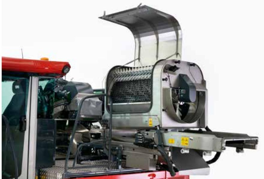
Un nettoyage simple et rapide: brosse et panier sont faciles à démonter, la table de tri sort complètement. L'égrappoir reste propre lorsque le convoyeur est fermé (photo).
