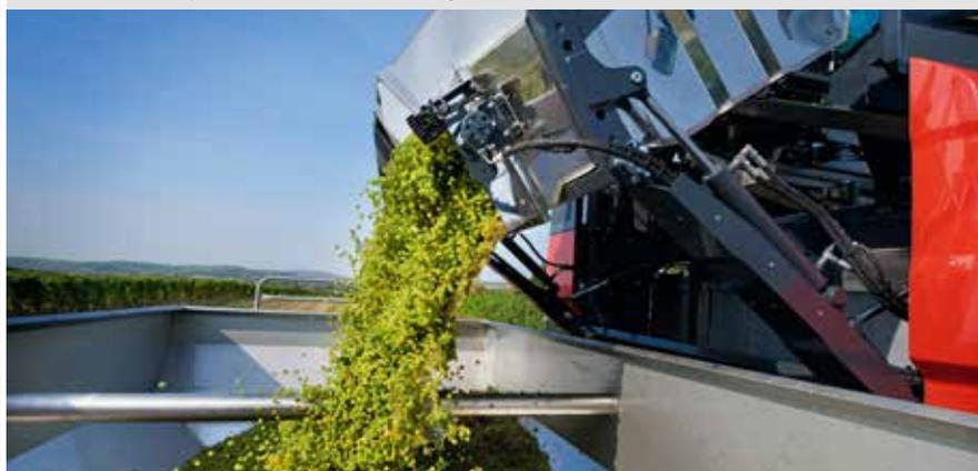
Un déchargement rapide ne nécessitant aucune manœuvre pour préserver les baies: La trémie latérale.
