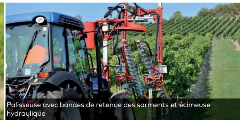
Palisseuse avec bandes de retenue des sarments et éciméuse hydraulique
