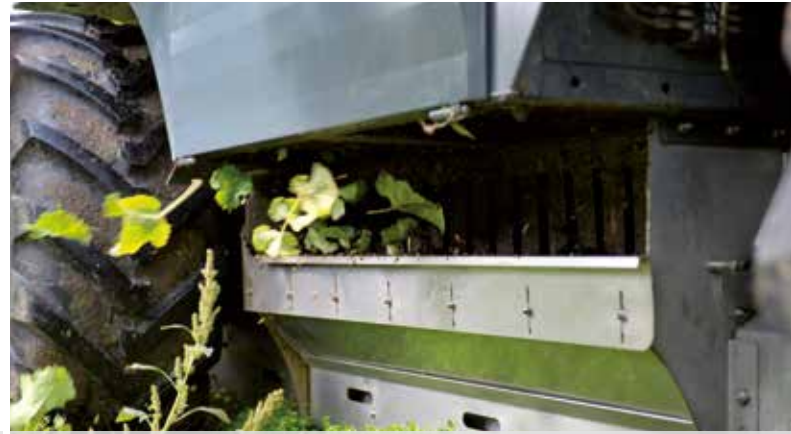
Extracteur de feuilles et buse à air transversal éliminent une partie des feuilles avant le contact avec le raisin.
