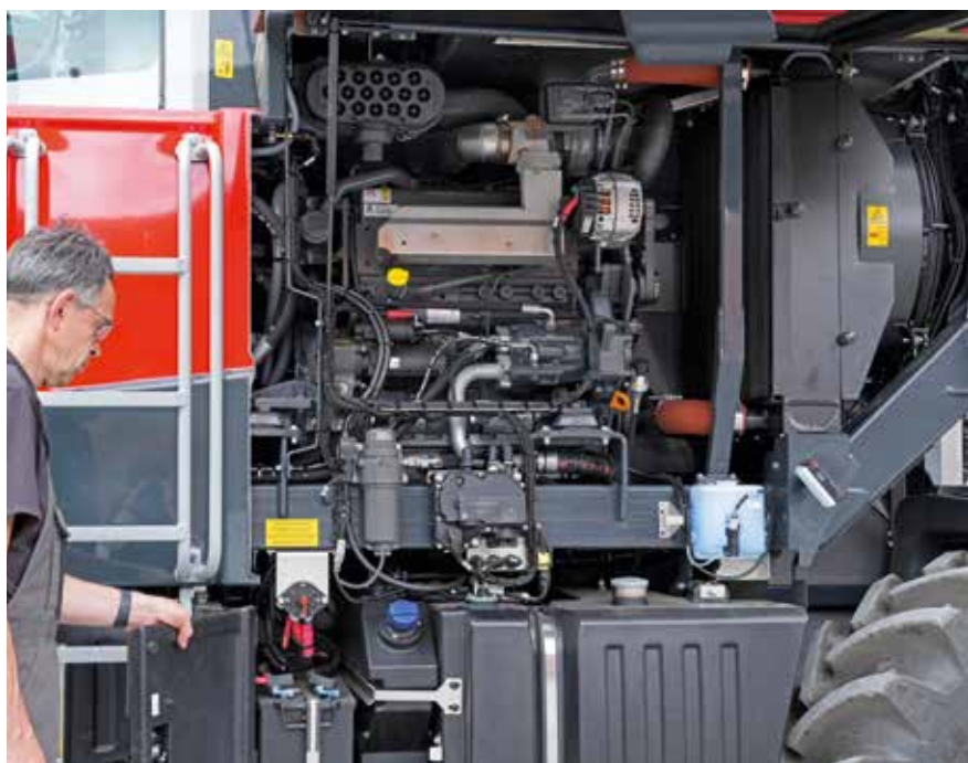
Trois variantes de moteur AGCO Power. Ouverture rapide du capot pour les travaux de maintenance.
