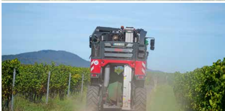
Le freinage sur 4 roues raccourcit la distance de freinage, un atout même à la vitesse maximale.
