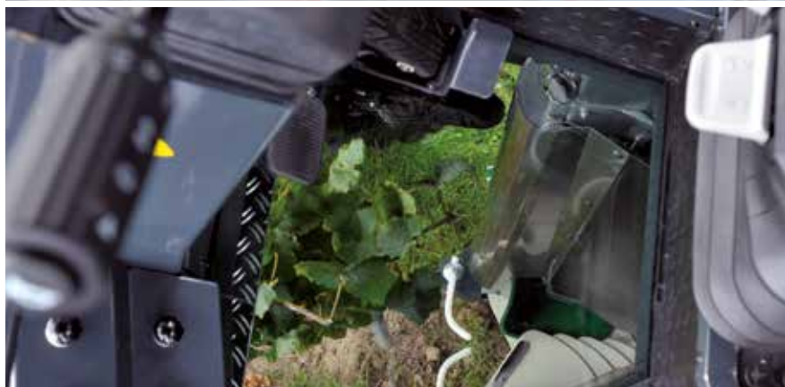
Le plancher vitré de la cabine offre une vue dégagée sur le rang de vigne.
