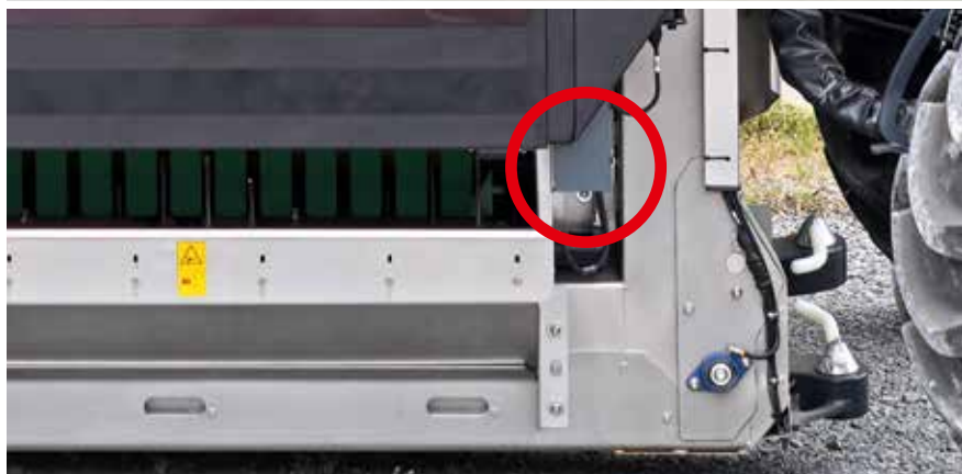
Affichage de la hauteur via un capteur à ultrasons.
