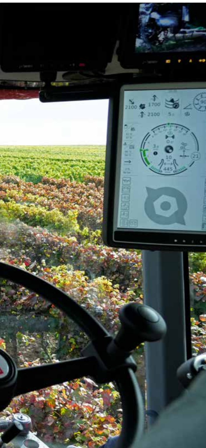
Le joystick ergonomique commande les fonctionnalités essentielles.
