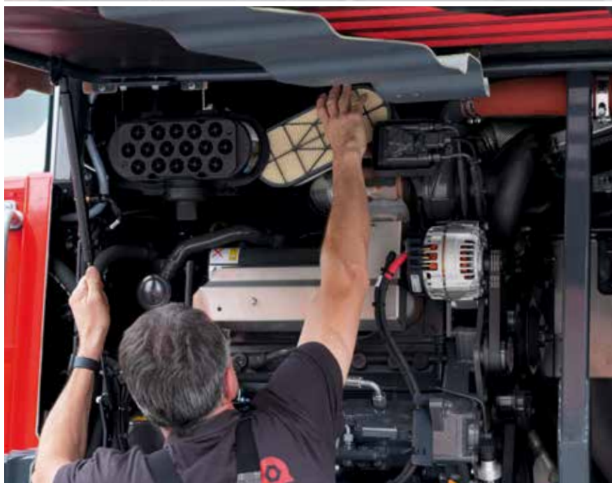
Le filtre à air se remplace en un tour de main.
