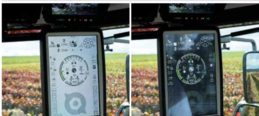
Le régulateur automatique de vitesse garantit une vitesse de récolte constante. L'écran intuitif dispose d'un mode jour et d'un mode nuit.
