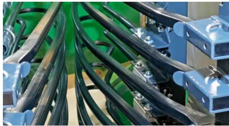
La section rectangulaire des secoueurs garantit une usure régulière et une durée de vie rallongée.
