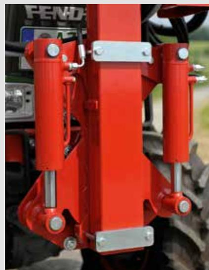
Supporto della colonna con brandeggio idraulico rinforzato (54°, 2 pistoni)
