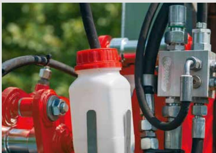
La valvola di limitazione della pressione, da 6 bar, protegge il motore della cimatrice da picchi di pressione nel ritorno, nonché da errori di comando e di impiego.
