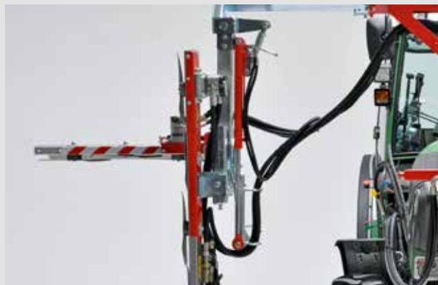
Regolazione idraulica dell'altezza delle barre di taglio orizzontali (40 cm)
