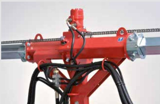
Regolazione idraulica della larghezza dei moduli di taglio: diversi telaietti permettono la lavorazione di interfilari fra 1,38 m e 3,50 m.
