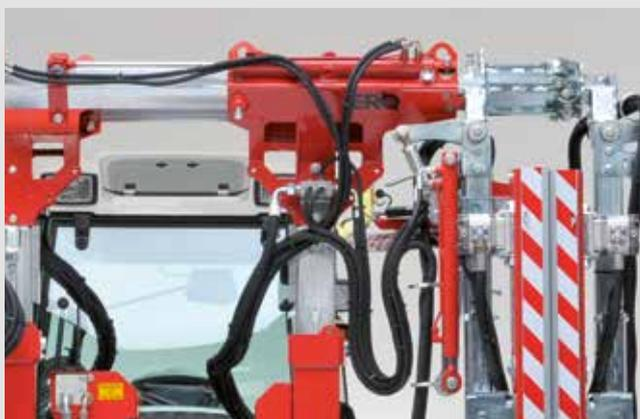
Spostamento laterale idraulico (40 cm)
