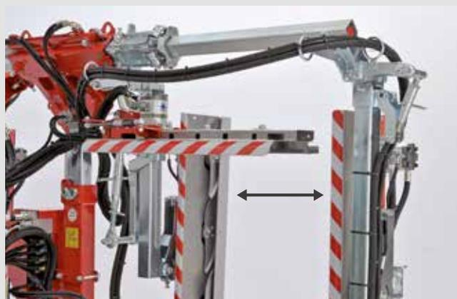
Regolazione idraulica della larghezza di taglio (versione a U rovesciata), 15 cm - 85 cm; per la ELITE Profi Line simple cordon 15 cm - 115 cm
