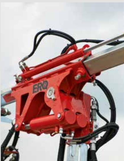
Cinematica Z, versione rinforzata con due cilindri, necessaria per cimatrici ERO modello ELITE unilaterale, scavallante, con larghezza di taglio da 185 cm e oltre.
