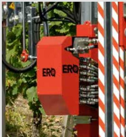
Comando elettro-idraulico Comfort con joystick (versione base, solo per modello ELITE)
