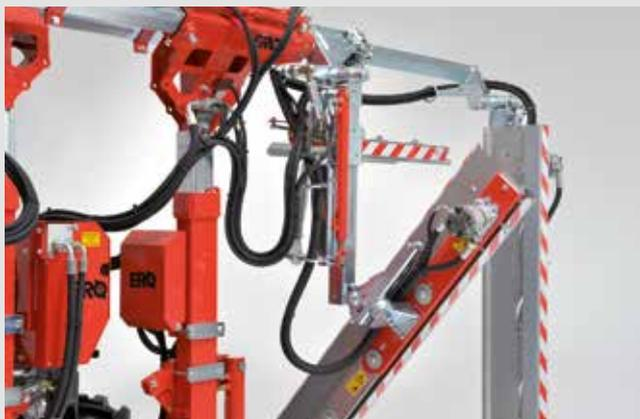
Dispositivo di sicurezza a rientro tramite pistone a gas sulle barre orizzontali e verticali con ritorno automatico
