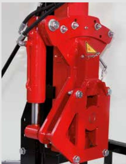
Supporto della colonna con brandeggio idraulico (54°)
