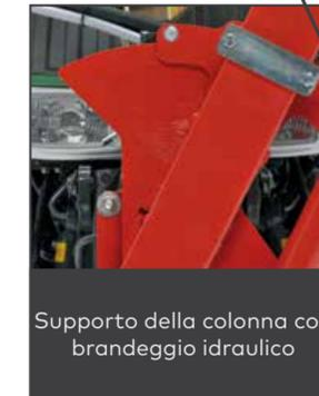
Supporto della colonna con brandeggio idraulico
