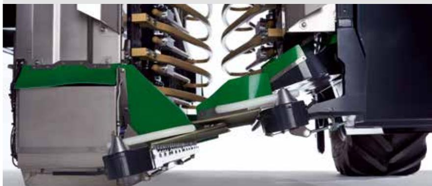
Meno usura, meno tempo e costi di manutenzione e pulizia sono i pregi del sistema di trasporto su un lato. La regolazione dell'angolo di inclinazione dei due canali a scaglie garantisce il flusso di materiale ottimale.
