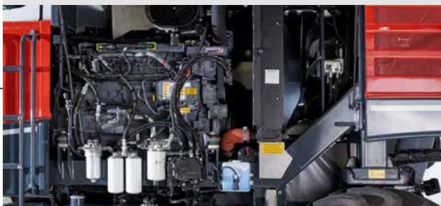
Motore DEUTZ® di ultima generazione in due classi di potenza: 6 cilindri, cilindrata 6057 cm<sup>3</sup>, livello delle emissioni EURO 5 da 175 PS oppure 204 PS
