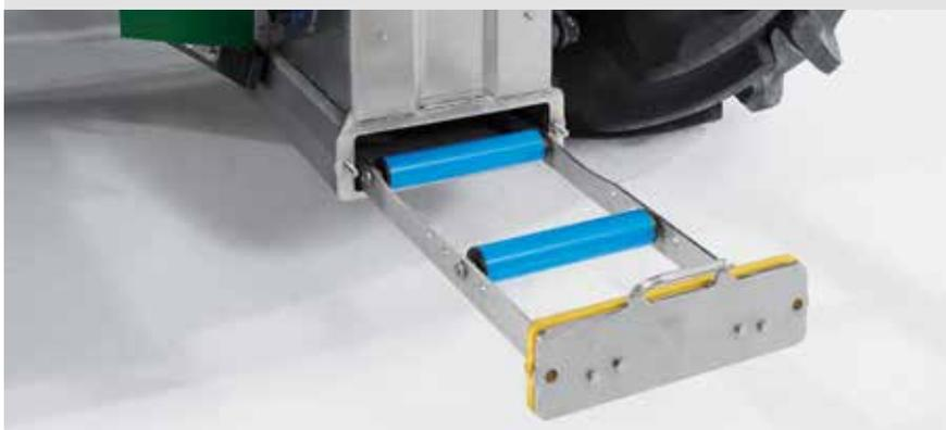
La guida a rulli sotto il nastro di trasporto riduce l'attrito e di conseguenza l'usura del nastro di trasporto. Facile da estrarre per la pulizia.
