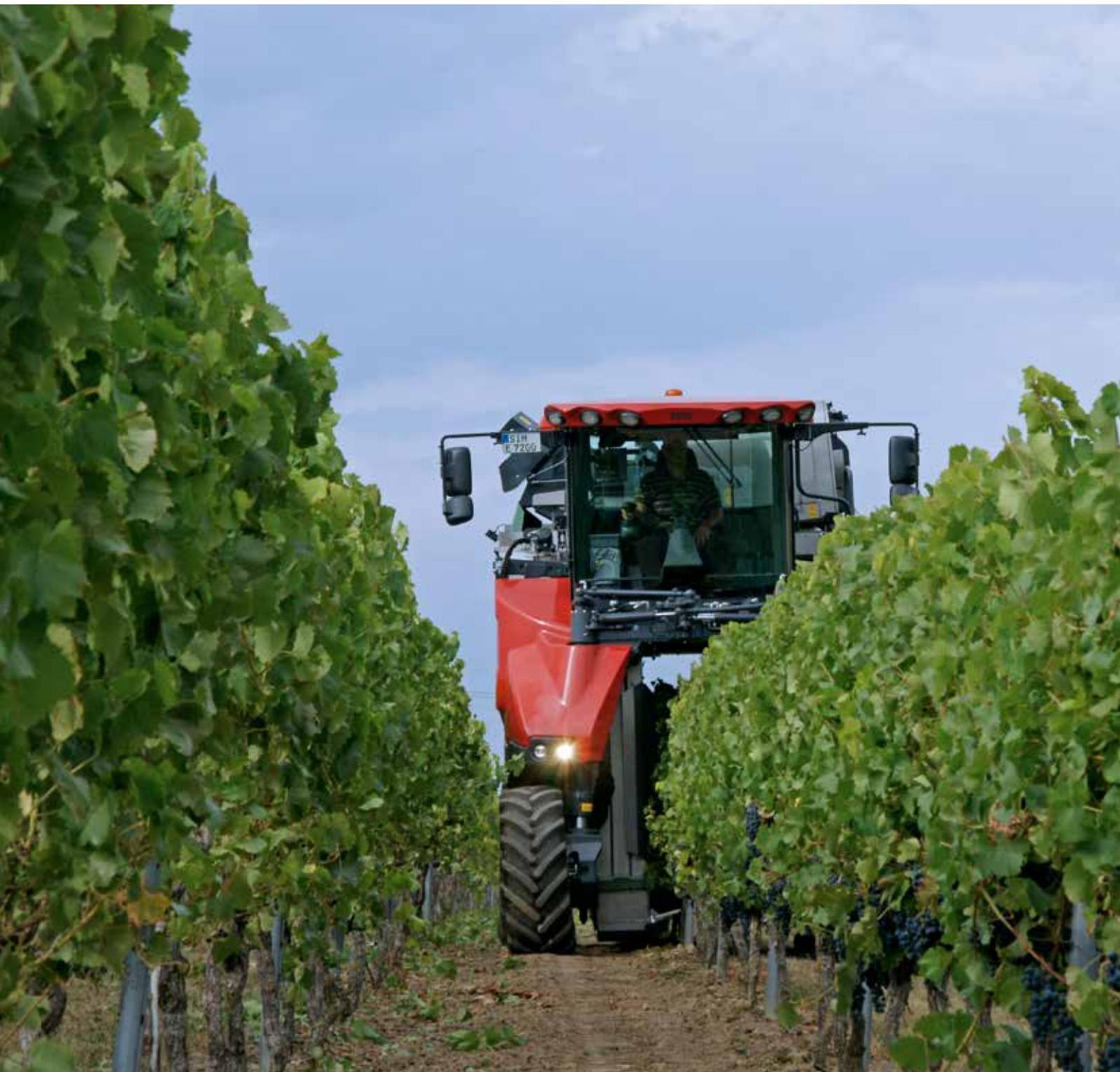
Il sistema di selezione VITselect abbinato al diraspatore garantisce un prodotto perfetto nel serbatoio. I contaminanti residui vengono eliminati in modo mirato.
