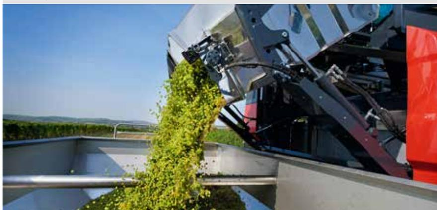
Vuotare il serbatoio velocemente mantenendo il prodotto intatto, senza fare manovra: Il serbatoio ribaltabile lateralmente.
