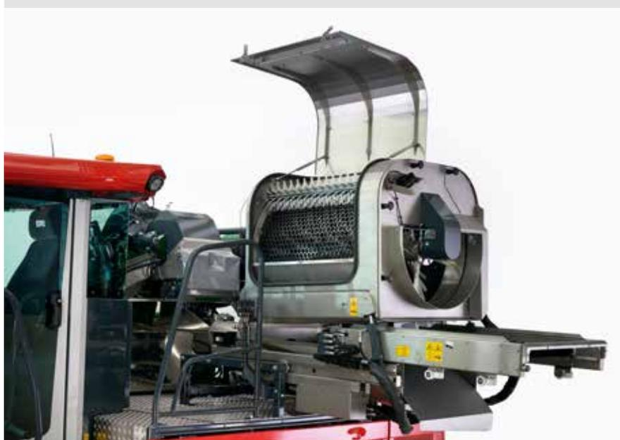
Si pulisce bene e facilmente: La spazzola, il tamburo e l'albero a spine del diraspatore si rimuovono con facilità, il selezionatore si estrae completamente. Quando il nastro di trasporto è chiuso (foto) il diraspatore resta pulito.
