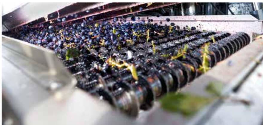
I rulli del selezionatore sempre sott'occhio Regolazione idraulica della distanza e della velocità dal sedile di guida.
