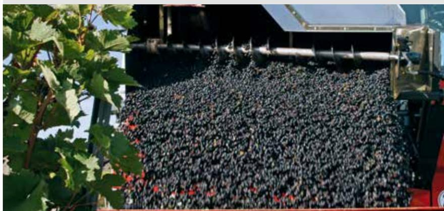
La larghezza standard di scarico, pari a 1,80 m, si può ridurre gradualmente fino a un minimo di 85 cm.
