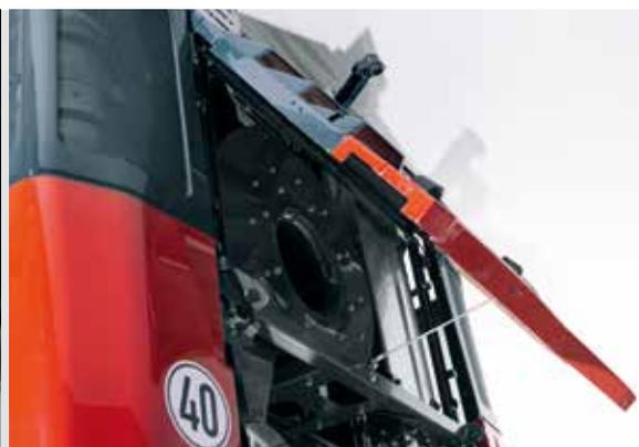
I raschiatori di filare sono leggeri, si staccano per effettuare interventi di pulizia e di manutenzione e si riattaccano con facilità.
