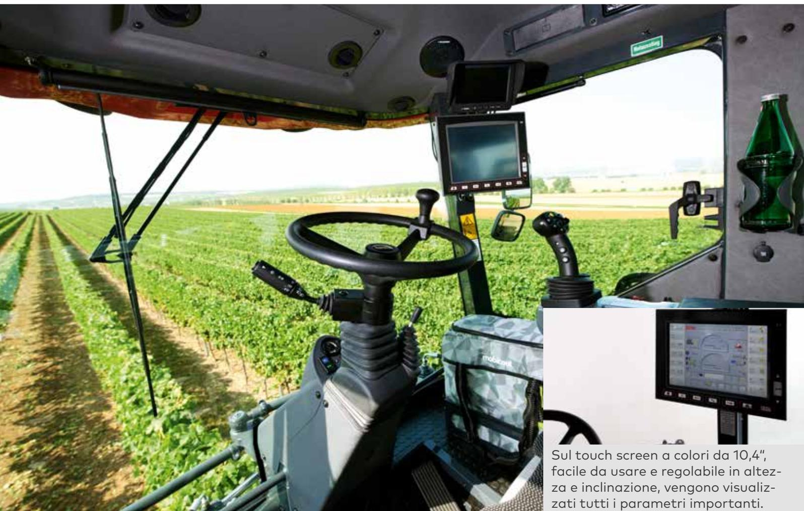
Sul touch screen a colori da 10,4", facile da usare e regolabile in altezza e inclinazione, vengono visualizzati tutti i parametri importanti.
