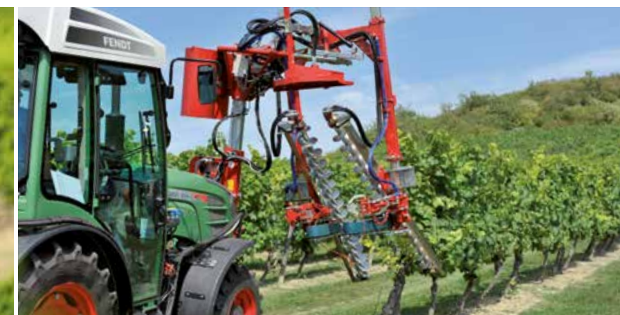
Legatrice con nastri in gomma guida-tralci e coltello superiore
