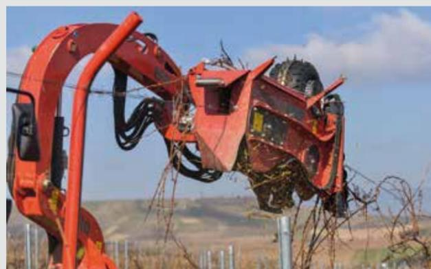
Testata di lavoro trituratrice per guyot Viteco con possibilità di regolazioni idrauliche su due assi
